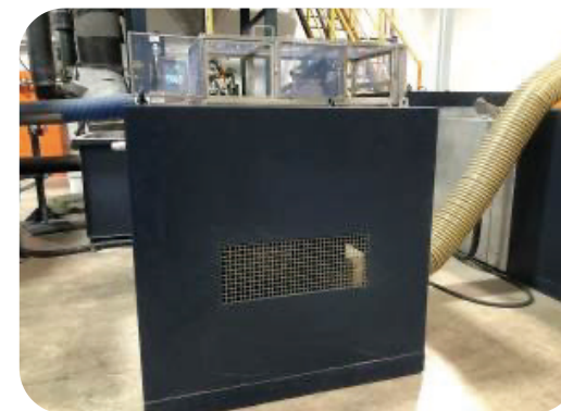
魯式鼓風機增設隔音罩降低噪音
